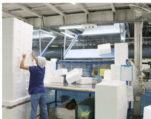
金型成形により発泡スチロール製品が次々と製造される
