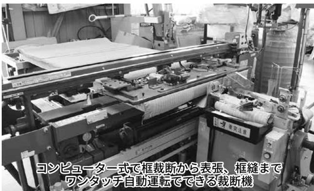
コンピューター式で框裁断から表張、框縫までワンタッチ自動運転でできる裁断機
