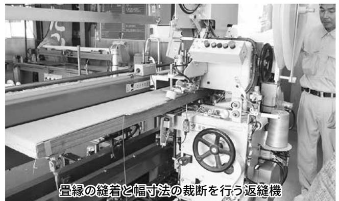
畳縁の縫着と幅寸法の裁断を行う返縫機
