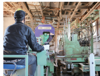
新たに導入したNTBシステムを使った大割作業
