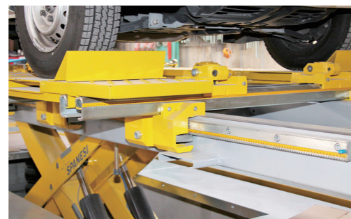
修正機についた目盛りで実測値を確認しながら作業できる
