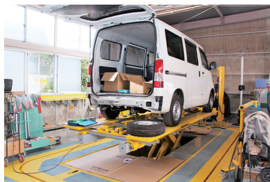
整備車両を乗せた「フレーム修正機」
