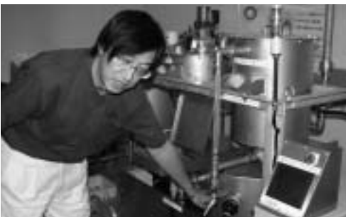
廃食用油からBDFを精製する実験装置
