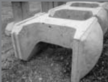
廃棄物から製造される「水砕溶融スラグ」を使ったコンクリートブロック
