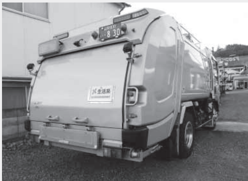
共通プレートを設置したパッカー車
