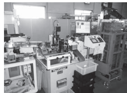
高速画像検査処理装置
