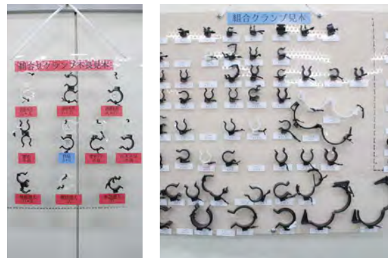
組み合わせ見本 不良と正しいものが示されている
