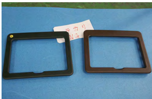
カップホルダー部品。かすかに見えるテカリの部分が不良
