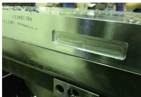
組立完成後のテストカット
