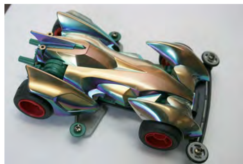
カラースパッタリングで色付けしたラジコンカー
