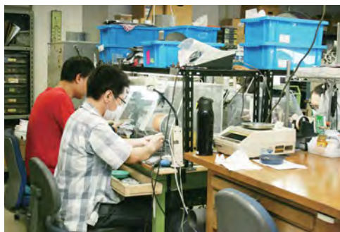
職人が地金を一つ一つ研磨する磨きの工程
