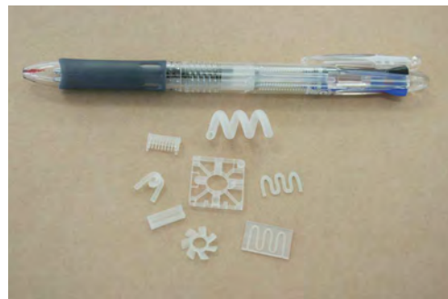
3Dプリンターで作ったモデルは指先に乗るほど小さい
