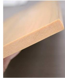
◀ 多層押出成形したものの表層部分が見える
