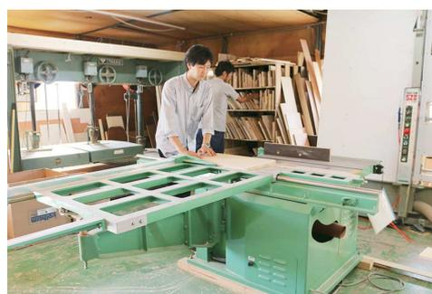
今回導入した軸傾斜横切盤、内装家具の製作の効率化とデザイン性がアップした。
