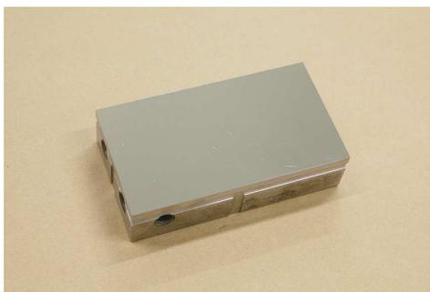
◀ ナノ加工機を使って製作した金型のコマ
