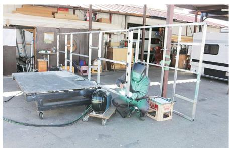
新しい溶接装置の導入により、アルミフレーム製作の高品質化と効率化を図ることに成功した。
