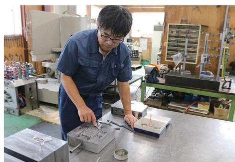
◀ 金型製造では磨きなど手作業で行われる工程も多い
