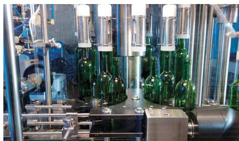
充填装置によるボトリング風景
