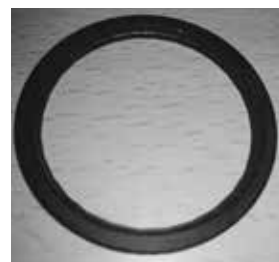
モデリングマシンで試作した時計のベゼル
