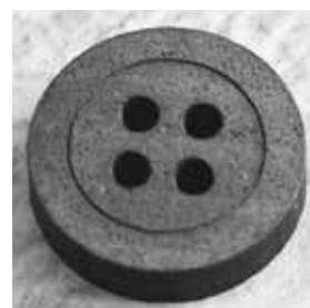
レーザー加工機で試作したボタン
