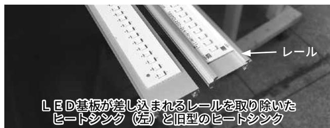
一方、「分離型」は電源回路とLEDのスペースが別々なため熱がこもらず、LEDやコンデンサーの劣化が進みにくく、背面部のヒートシンクも狭いスペースで足りることから、光を出す範囲を広く確保でき14～18Wと低い消費電力でも明るく目にも優しい光になる。その反面、取付工事に手間がかか
