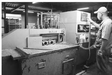
導入したNC丸鋸切断機
