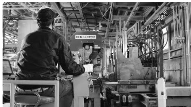
遠隔操作で製材作業が可能となり作業員の安全性が向上
