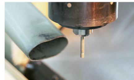
●先端にダイヤモンド粒子の砥石が付いた軸が超高速回転し、金型に穴加工する
