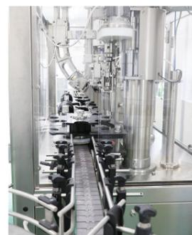
● 中央のレーンに瓶を乗せるだけで洗浄、充填、打栓を行う
