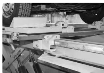
修正機についた目盛で、実測値を確認しながら作業できる
