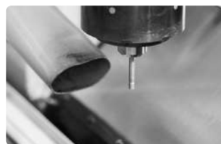
先端にダイヤモンド粒子の砥石が付いた軸が超高速回転し、金型に穴加工する
