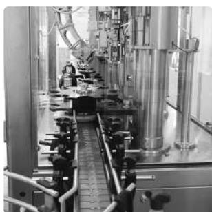
中央のレールに瓶を乗せるだけで洗浄、充填、打栓を行う
