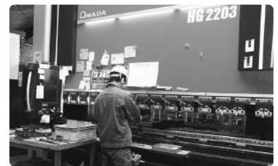
「バンドCAM」のデータをもとに 曲げ加工を行う
