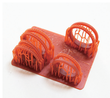
● 樹脂造形したパーツ サポートによって形を保 持する
