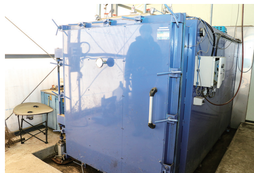
● 菌床玉を 500 個格納できる常圧殺菌釜
