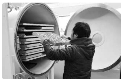
フルーツを一度に50kg乾燥できる 「真空凍結乾燥装置」
