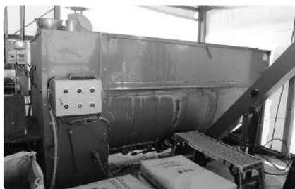
菌床培地の原料を混ぜ合わせる攪拌機
